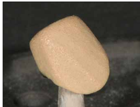
Durch einfaches Auftragen des goldfarbenen Base Opakers werden herausragende Verbundwerte zu den Aufbrennlegierungen erreicht.
