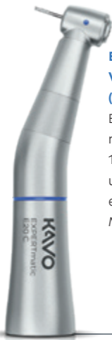
EXPERTmatic Übersetzungs-Winkelstück E25 C (1:5, ohne Licht) Hartmetallführungsbuchse, zügiges und präzises Arbeiten durch noch kleineren Kopf, flexible Rastnase und Keramik-Kugellager, 3-Düsen Spray und auswechselbarer Sprayfilter, Spraywasser und Sprayluft innengeführt Mat.-Nr. 1.007.5551
