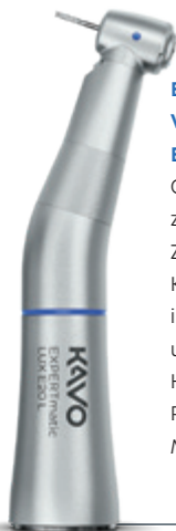
EXPERTmatic LUX Übersetzungs-Winkelstück E25 L (1:5) Hartmetallführungsbuchse, Glasstab-Lichtleiter mit bis zu 25.000 Lux, zügiges, präzises Arbeiten durch kleinen Kopf, flexible Rastnase und Keramik-Kugellager, Spraywasser und Sprayluft innengeführt, 3-Düsen Spray und auswechselbarer Sprayfilter Mat.-Nr. 1.007.5550
