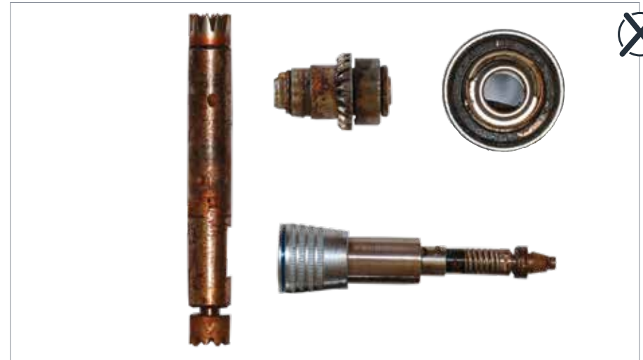
Pièces à main mal entretenues
